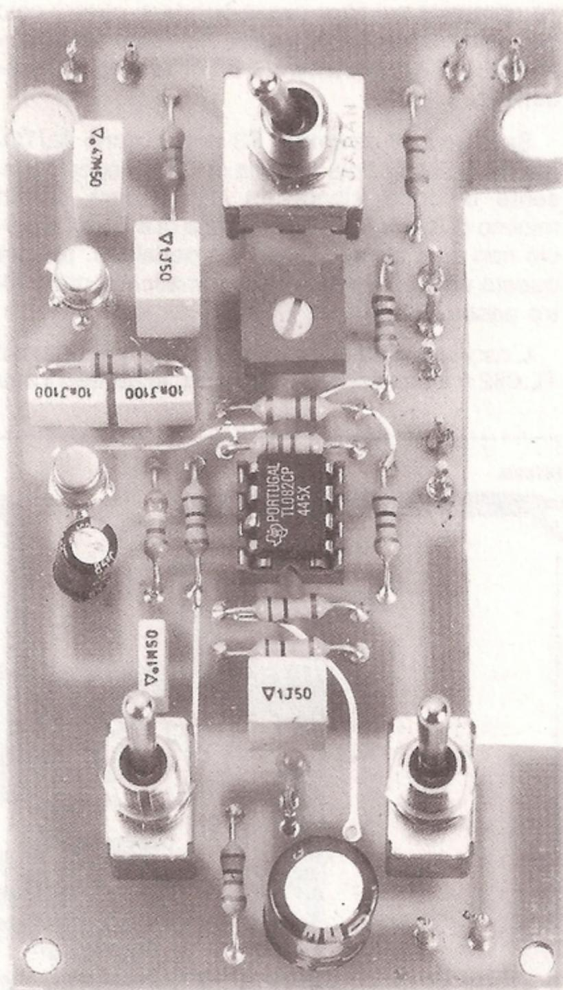
**Fig.3** In questa foto ingrandita potrete facilmente osservare come risultano disposti tutti i componenti e in che posizione dovreste inserire i tre deviatori a levetta.
