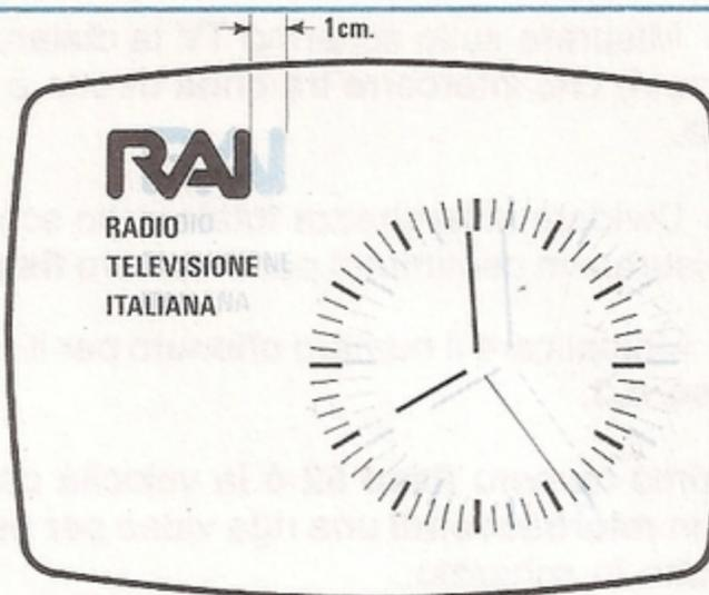
**Fig. 13** Misurando la distanza che intercorre tra l'immagine diretta e quella riflessa, è possibile determinare approssimativamente a quale distanza dalla vostra antenna si verifica tale riflessione (leggere articolo).
