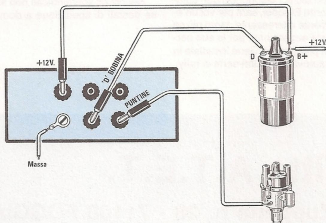
**Fig. 31** In caso di avaria potrete facilmente reinserire nella vostra auto la tradizionale accensione ed escludere quella elettronica, spostando le due boccole sopra "D bobina AT" e "puntine" sulle due boccole poste in basso. Queste due boccole andranno collegate internamente insieme, per congiungere il D della bobina alle puntine dello spinterogeno.
