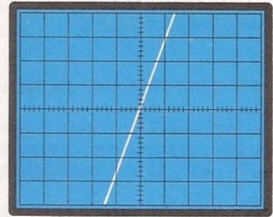
Fig. 24 Se sullo schermo appare questa linea inclinata, diversa dalla fig.22, il Triac è in cortocircuito.
