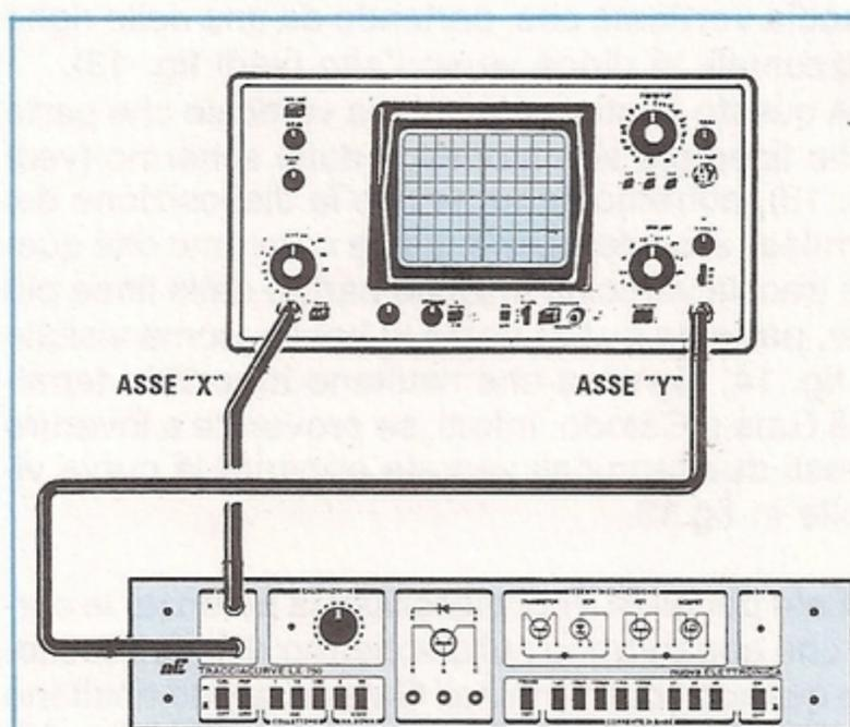
**Fig. 5** L'oscilloscopio andrà collegato al tracciacurve come visibile nel disegno, con i comandi AC-GND-CC in posizione CC, la sensibilità "orizzontale" in posizione 1 volt x quadretto e quella "verticale" in 0,5 volt x quadretto.
