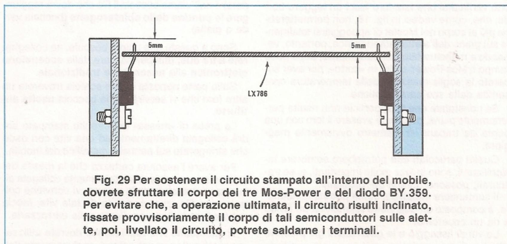
**Fig. 29** Per sostenere il circuito stampato all'interno del mobile, dovrete sfruttare il corpo dei tre Mos-Power e del diodo BY.359. Per evitare che, a operazione ultimata, il circuito risulti inclinato, fissate provvisoriamente il corpo di tali semiconduttori sulle alette, poi, livellato il circuito, potrete saldarne i terminali.
