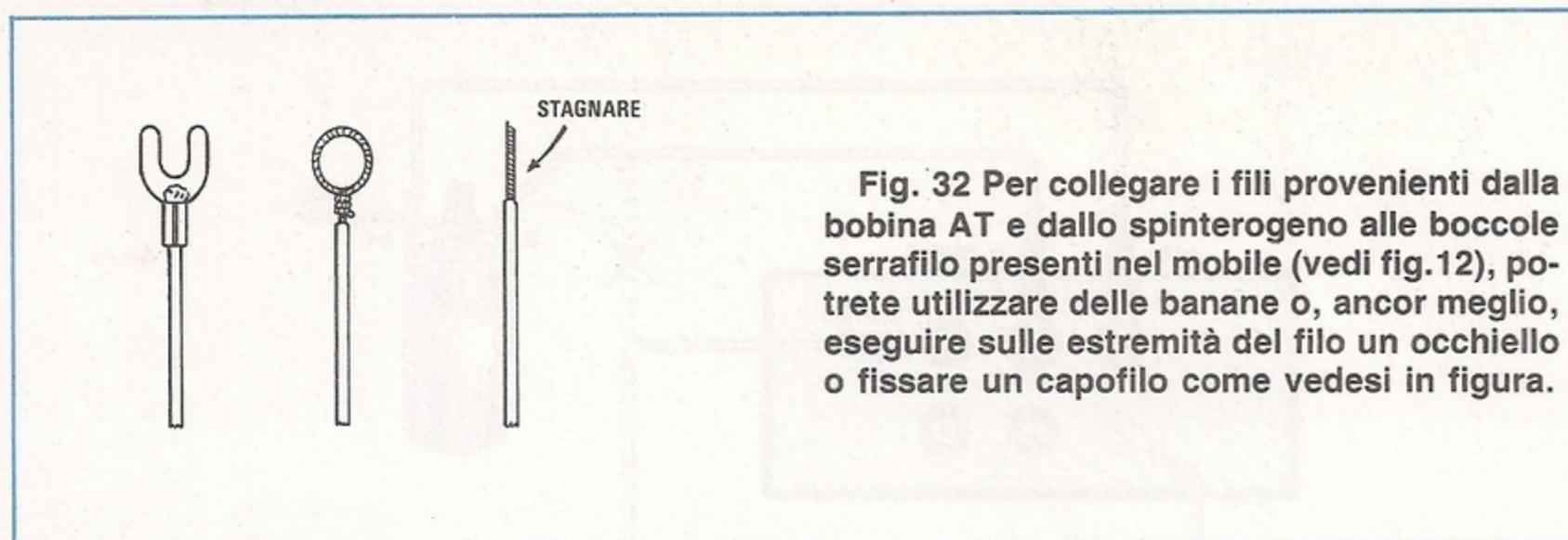
**Fig. 32** Per collegare i fili provenienti dalla bobina AT e dallo spinterogeno alle boccole serrafilo presenti nel mobile (vedi fig.12), potrete utilizzare delle banane o, ancor meglio, eseguire sulle estremità del filo un occhiello o fissare un capofilo come vedesi in figura.
