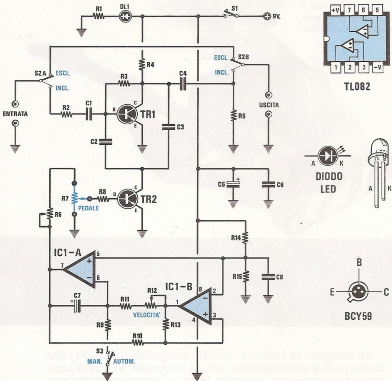
Fig.1 Schema elettrico dello Wa-Wa descritto nell'articolo. Di lato le connessioni dell'integrato TL.082 visto da sopra e del transistor BCY59 visto invece da sotto. Ricordatevi che il terminale più lungo del diodo led è l'Anodo.
