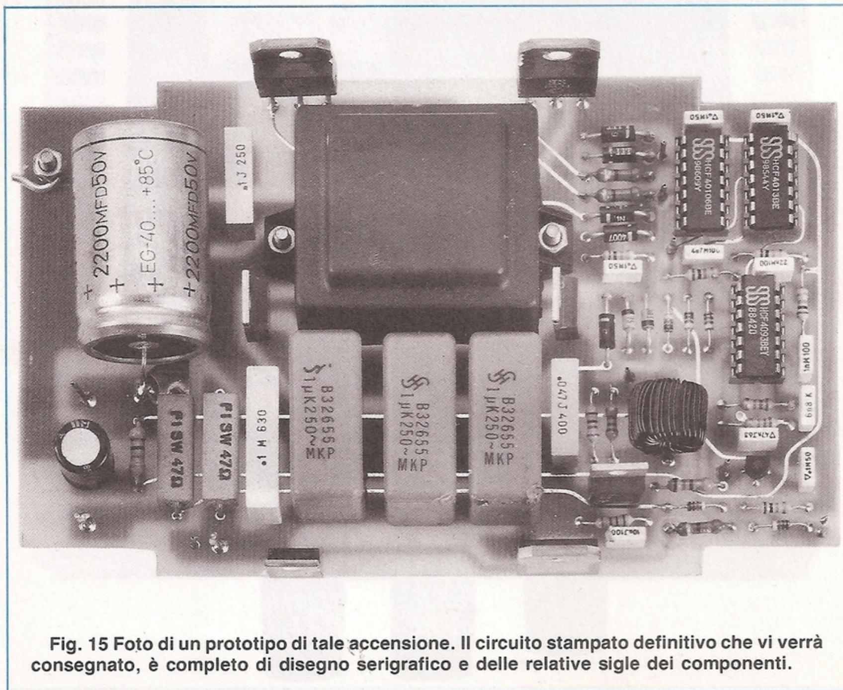
Fig. 15 Foto di un prototipo di tale accensione. Il circuito stampato definitivo che vi verrà consegnato, è completo di disegno serigrafico e delle relative sigle dei componenti.
