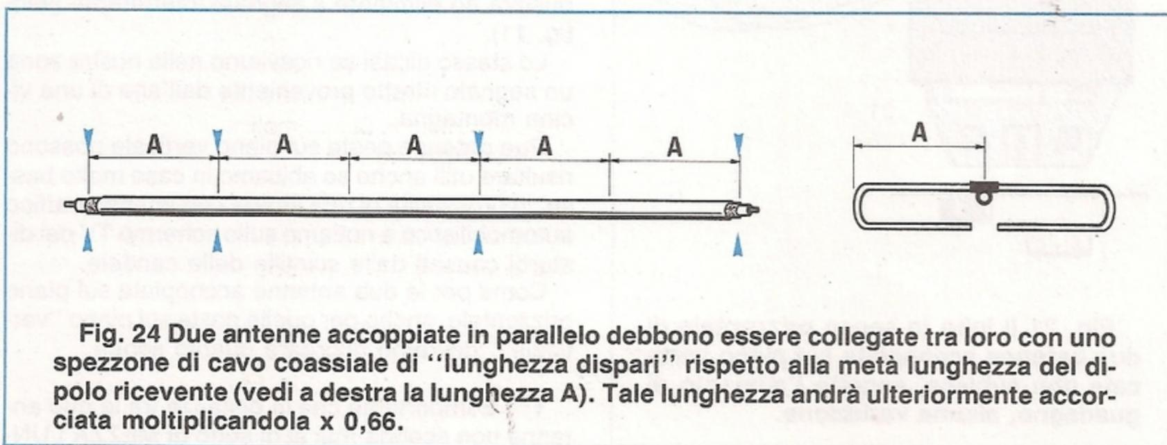
Come già abbiamo visto nell'esempio precedente, per stabilire molto velocemente tali lunghezze senza dover eseguire troppi calcoli, è possibile misurare la lunghezza del dipolo dell'antenna e, prendendo come riferimento la **metà di tale lunghezza**, moltiplicarla per 3 - 5 - 7 - 9 - 11 - 13 - 15 - ecc., per ottenere subito tutti i valori multipli dispari di un 1/4 d'onda.
