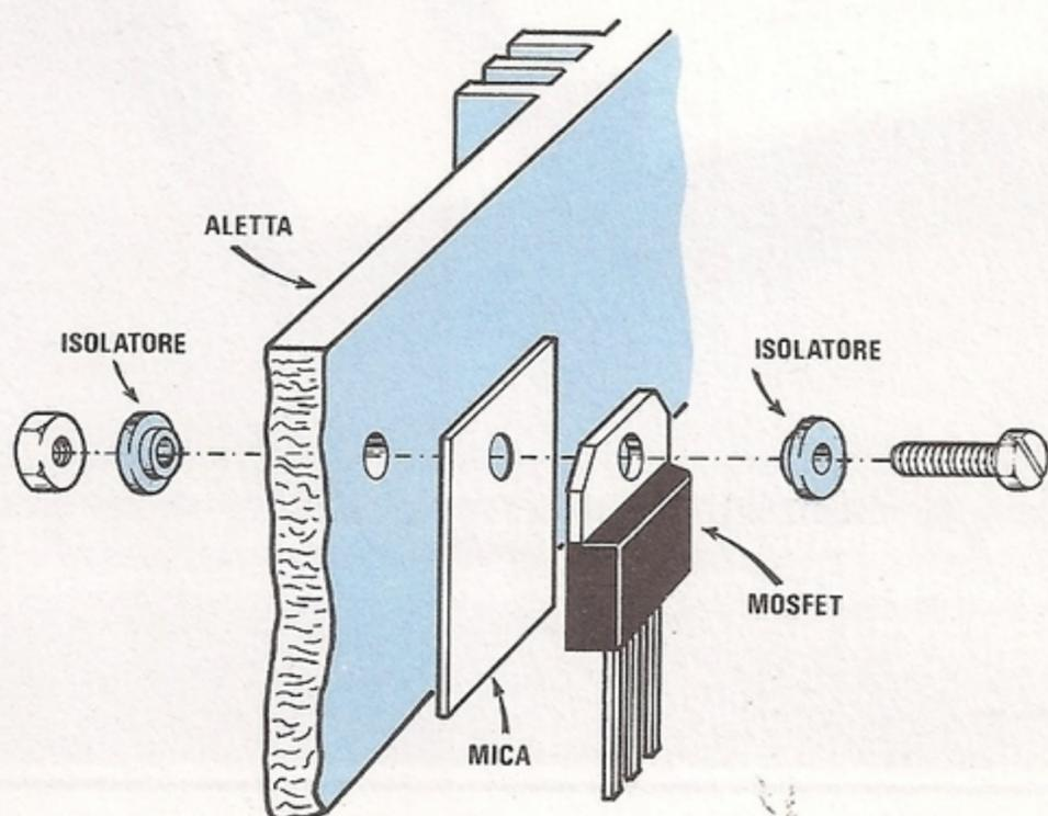
**Fig. 20** La parte metallica del corpo dei Mos-Power e anche quella del diodo BY.359, debbono risultare elettricamente isolate dall'ala di raffreddamento, pertanto, come vedesi in figura, dovrete utilizzare l'apposita mica isolante e le rondelle isolanti presenti nel kit.
