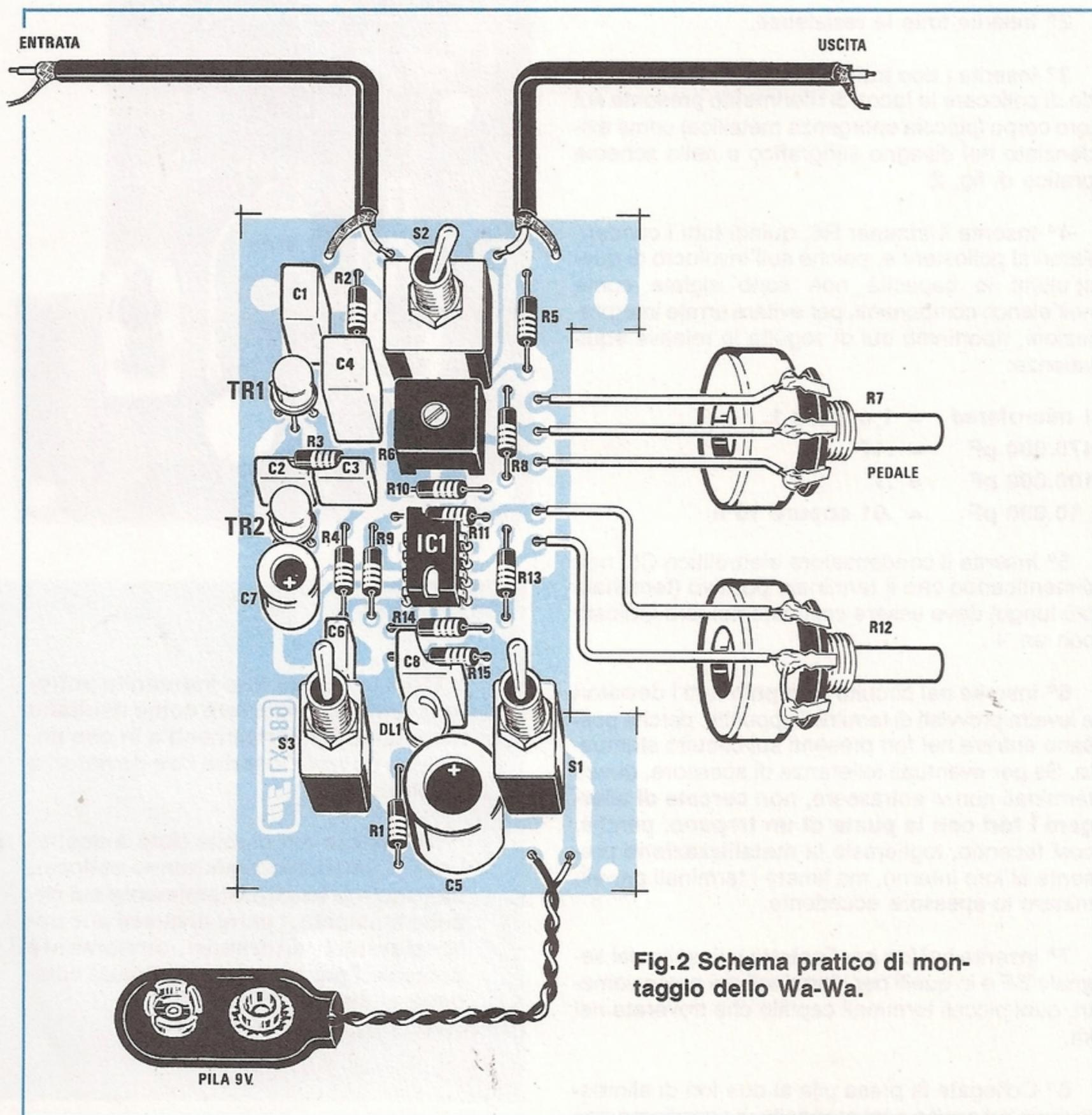
Fig.2 Schema pratico di montaggio dello Wa-Wa.
