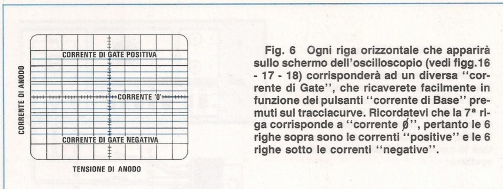
**Fig. 6** Ogni riga orizzontale che apparirà sullo schermo dell'oscilloscopio (vedi figg. 16 - 17 - 18) corrisponderà ad un diversa "corrente di Gate", che ricaverete facilmente in funzione dei pulsanti "corrente di Base" premuti sul tracciacurve. Ricordatevi che la 7<sup>a</sup> riga corrisponde a "corrente  $\emptyset$ ", pertanto le 6 righe sopra sono le correnti "positive" e le 6 righe sotto le correnti "negative".
