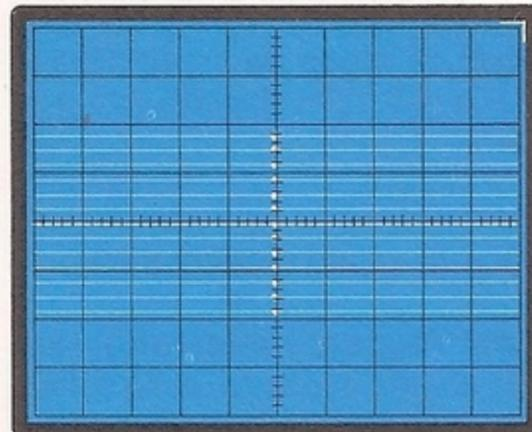
Fig. 16 Partendo dalla 7<sup>a</sup> riga, nelle righe sopra avremo la corrente positiva, in quelle sotto la negativa.
