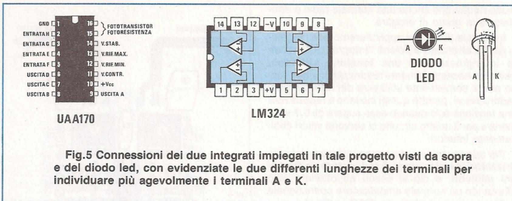
Fig.5 Connessioni dei due integrati impiegati in tale progetto visti da sopra e del diodo led, con evidenziate le due differenti lunghezze dei terminali per individuare più agevolmente i terminali A e K.
