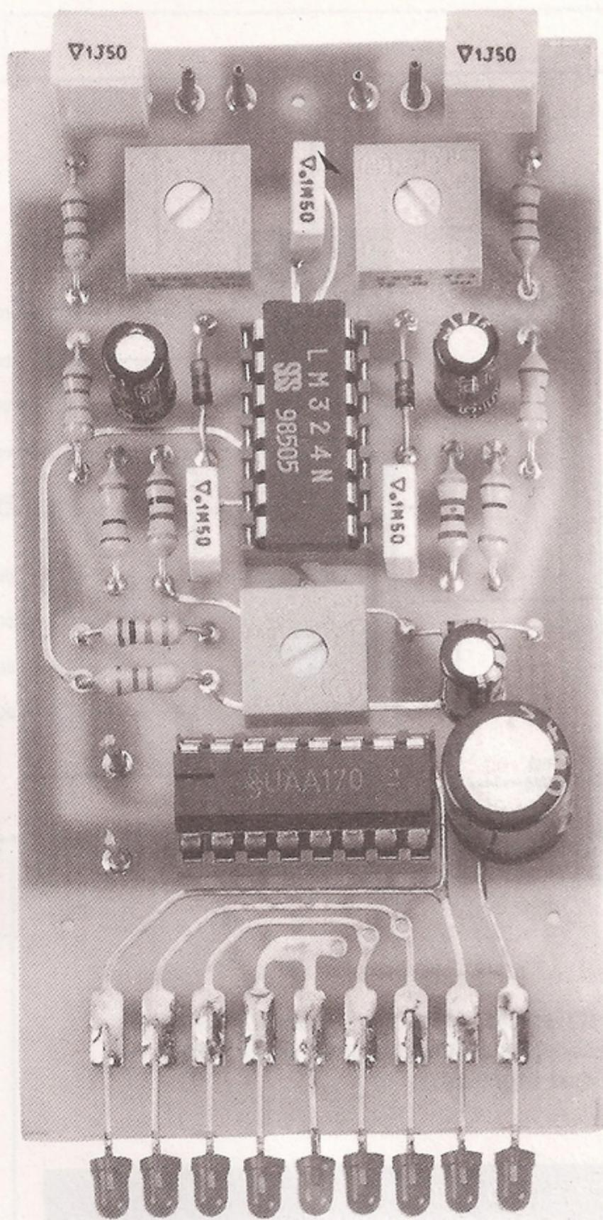
**Fig.1** Foto ingrandita del VU-Meter differenziale Stereo a diodi led, che potrà essere installato su amplificatori, radio, mangianastri, ecc. I terminali dei diodi led, come vedesi in questa foto, andranno infilati frontalmente nel circuito stampato.
