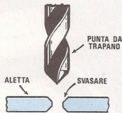
**Fig. 19** Se notate che il foro presente sull'ala risulta bordato, dovrete svasarlo con una punta da trapano.
