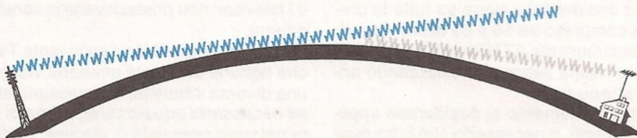
**Fig. 5** In pratica le onde elettromagnetiche non si propagano in linea diretta, ma a causa del fenomeno della "diffrazione", seguono leggermente la curvatura terrestre, per cui è possibile captare un segnale TV anche oltre il ristretto orizzonte ottico come visibile in disegno.
