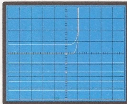
Fig. 20 Se si desidera una maggior precisione, si dovrà portare la 7<sup>a</sup> riga verso il basso (cioè escludere le 6 righe negative) e modificare la sensibilità verticale dell'oscilloscopio da 0,5 a 0,2 volt.
