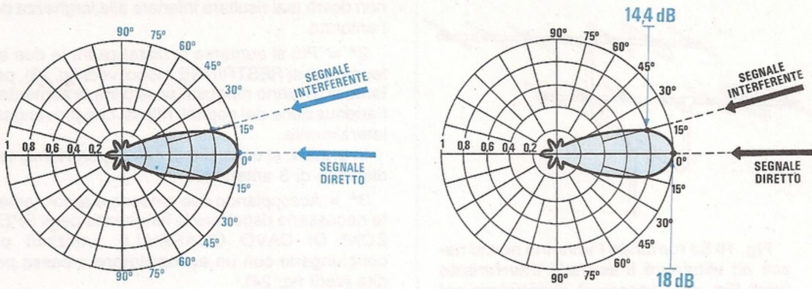
**Fig. 14** Un segnale "interferente", sia esso un'onda riflessa o il segnale di un'altra emittente, non raggiunge mai la nostra antenna sul lato frontale, ma quasi sempre lateralmente. Se l'antenna ha un guadagno di 18 dB ed il segnale interferente viene captato sul "lobo x 0,8" (vedi grafico a destra), tale segnale subisce un guadagno di ben 14,4 dB.
