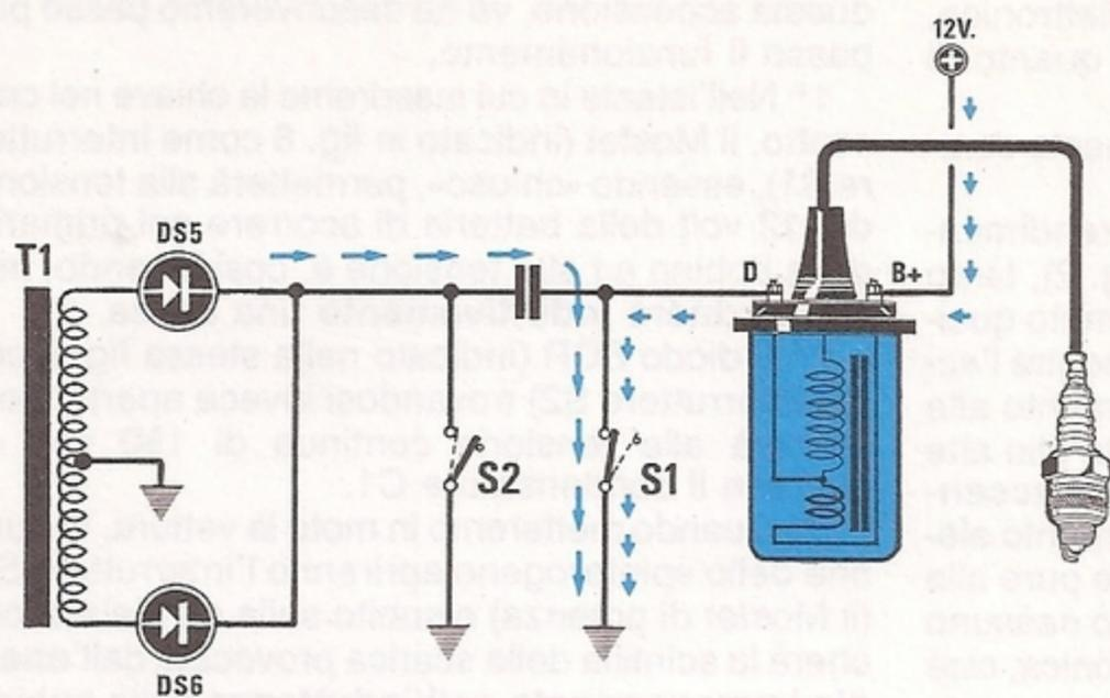
Fig. 8 Inserendo la chiave nel cruscotto, risultando chiuso l'interruttore S1 (MSFT3), nella bobina AT si immagazzinerà l'energia induttiva e nel condensatore quella capacitativa.
