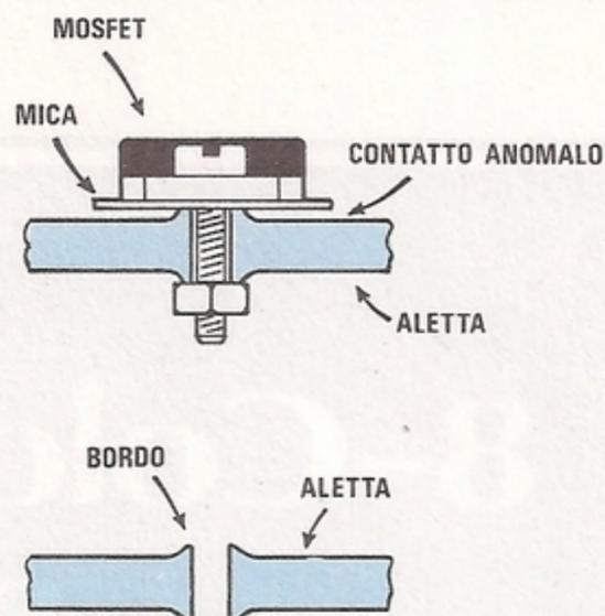
**Fig. 18** Se il corpo dei Mos-Power non aderirà perfettamente sul piano dell'ala di raffreddamento, potrà bruciarsi.
