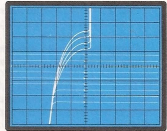
Fig. 30 Contando il numero delle tracce orizzontali non deviate, potrete determinare la corrente d'innescio.
