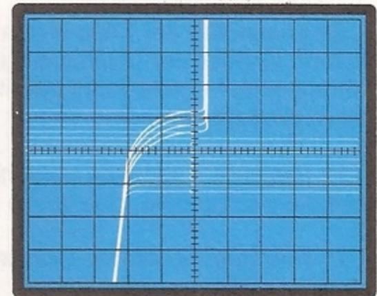
Fig. 27 Se la traccia superiore devierà nettamente verso l'alto, i terminali G e A1 sono inseriti correttamente.
