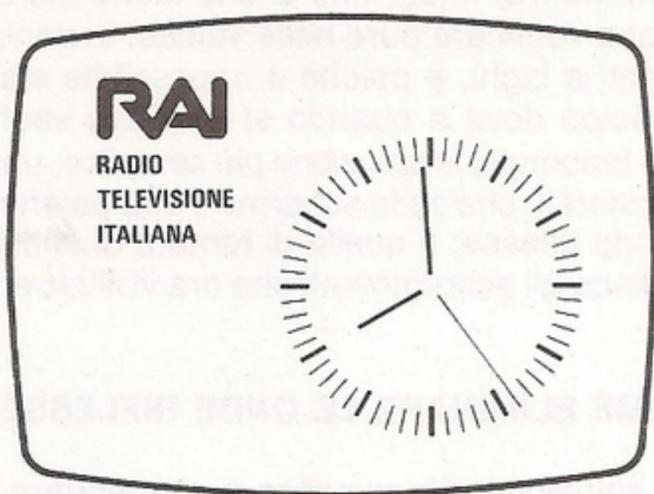
**Fig. 12** Una riflessione si rileva facilmente quando sulla TV appare, prima del giornale radio, l'immagine dell'orologio. Se è presente, noteremo una seconda immagine più spostata verso destra rispetto all'immagine diretta.
