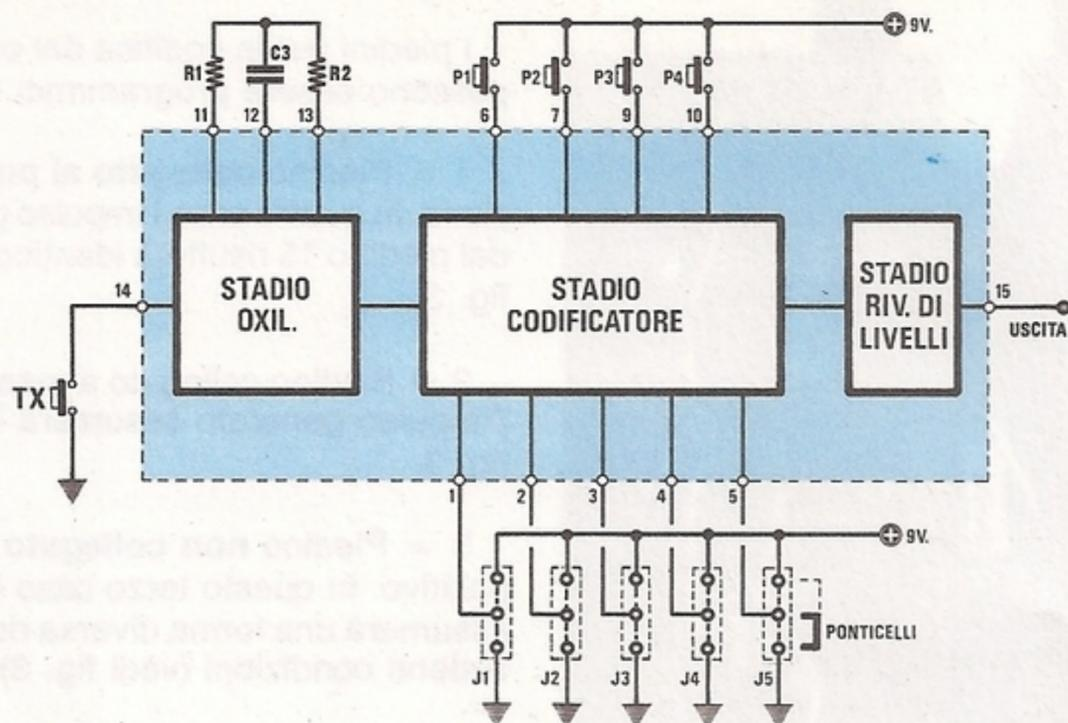
**Fig. 1** Schema a blocchi dell'integrato Encoder M.145026 utilizzato nel trasmettitore. Per codificare gli impulsi, dovreste collegare i piedini 1-2-3-4-5 in una delle tre posizioni Positivo, Massa o Aperto. Per eccitare il canale richiesto, dovreste premere assieme ad uno dei quattro pulsanti siglati P1-P2-P3-P4, anche il pulsante TX, per mettere in funzione lo stadio oscillatore. Nel nostro circuito il pulsante TX è stato sostituito da un transistor (vedi TR1 in fig.7).
