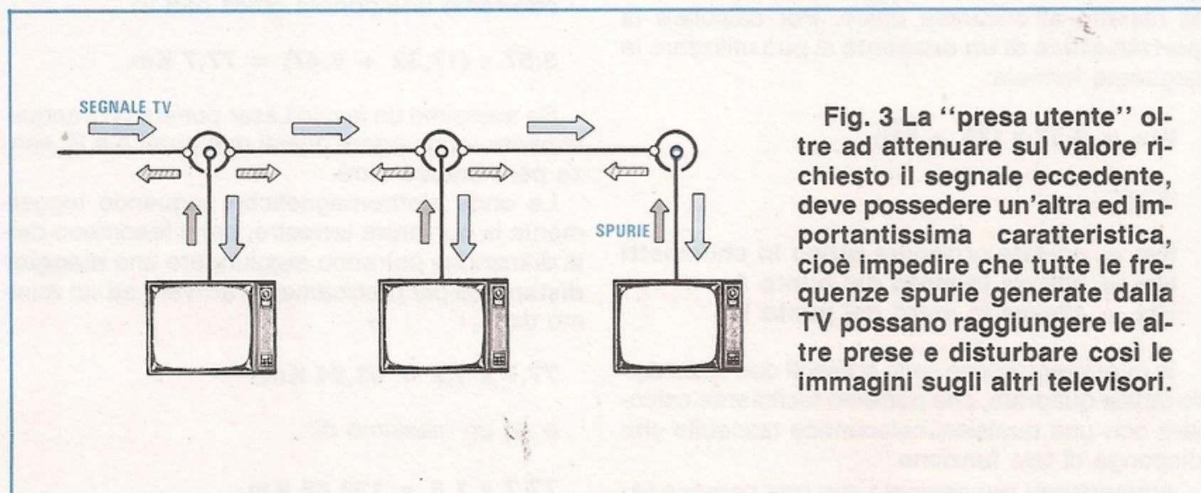
**Fig. 3** La "presa utente" oltre ad attenuare sul valore richiesto il segnale eccedente, deve possedere un'altra ed importantissima caratteristica, cioè impedire che tutte le frequenze spurie generate dalla TV possano raggiungere le altre prese e disturbare così le immagini sugli altri televisori.
