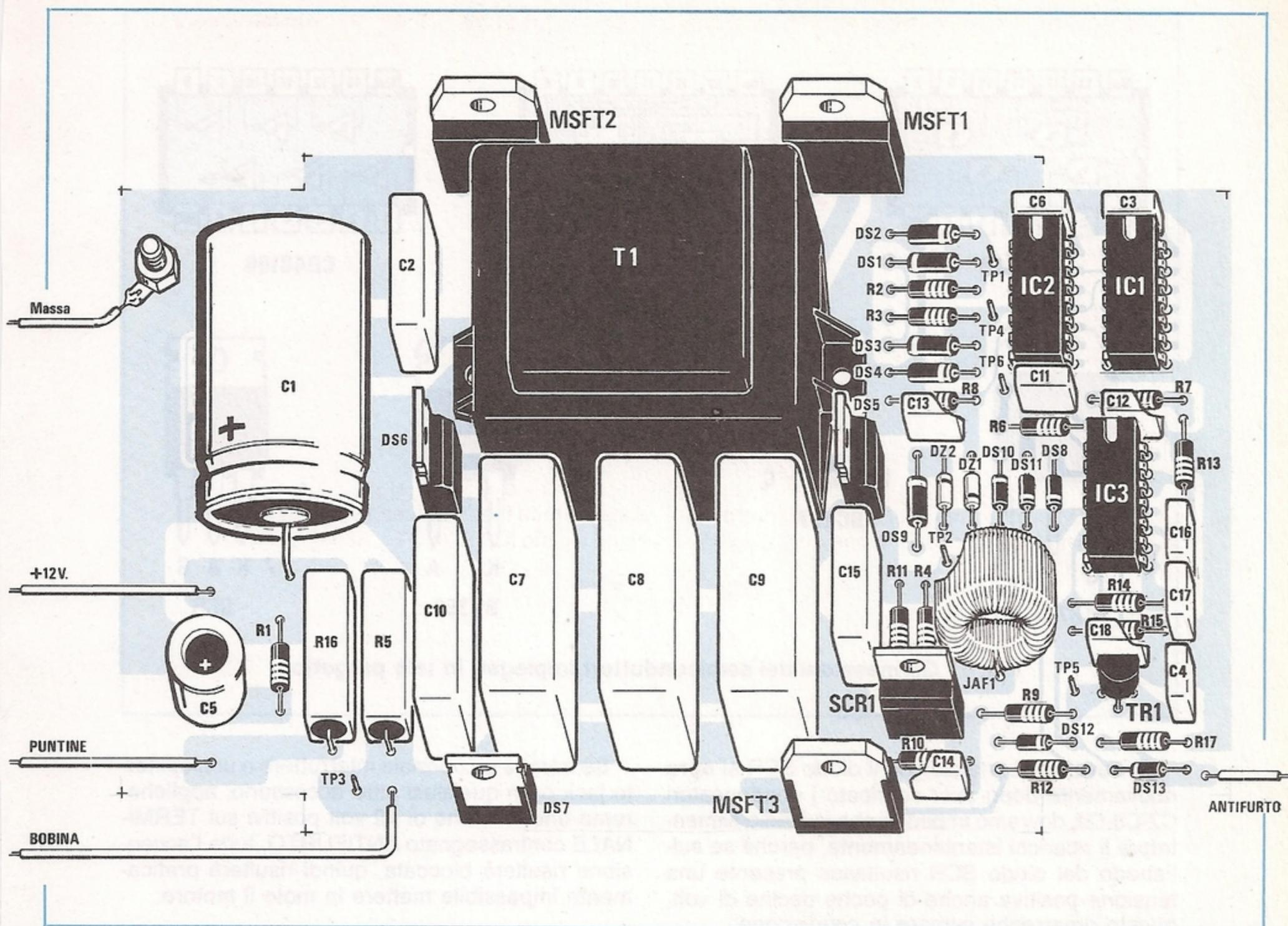
Fig. 16 Schema pratico di montaggio completo dei pochi fili che dovremo collegare ai morsetti presenti sul mobile. I terminali siglati con le lettere TP, sono punti di controllo per l'oscilloscopio.
