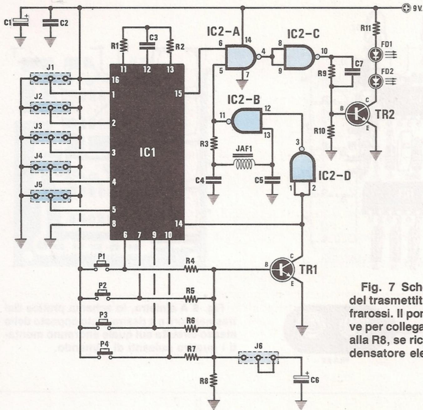
Fig. 7 Schema elettrico del trasmettitore a raggi infrarossi. Il ponticello J6 serve per collegare in parallelo alla R8, se richiesto, il condensatore elettrolitico C6.
