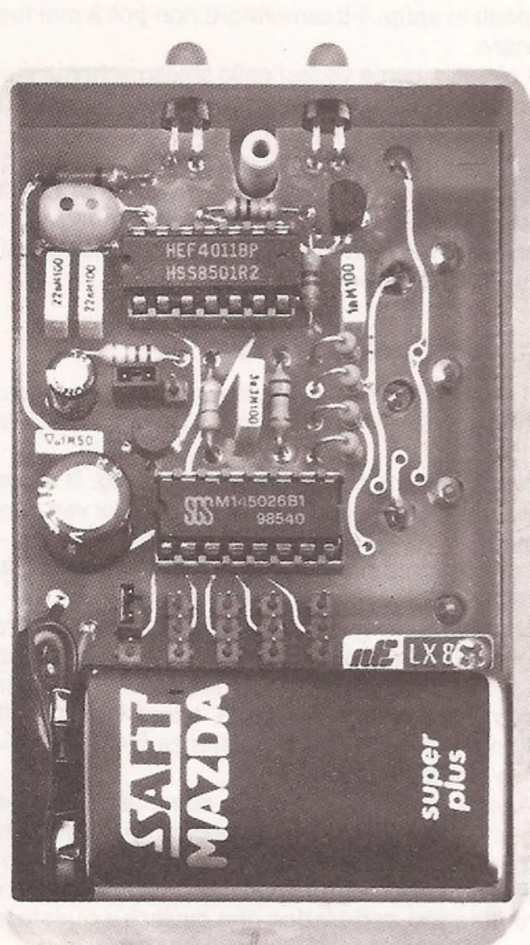
Fig. 10 In questa foto si può vedere come andrà collocato all'interno del mobile il circuito stampato e la relativa pila di alimentazione. Per far uscire la testa dei due led dalla scatola dovrete praticare due fori.
