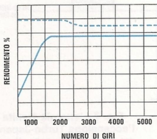
**Fig. 3** Poichè nella normale accensione elettronica la carica viene immagazzinata in un condensatore e non nella bobina AT, il rendimento risulta più lineare, anche se a basso numero di giri è sempre inferiore rispetto a quello fornito dall'energia induttiva come vedesi nel diagramma soprariportato.
