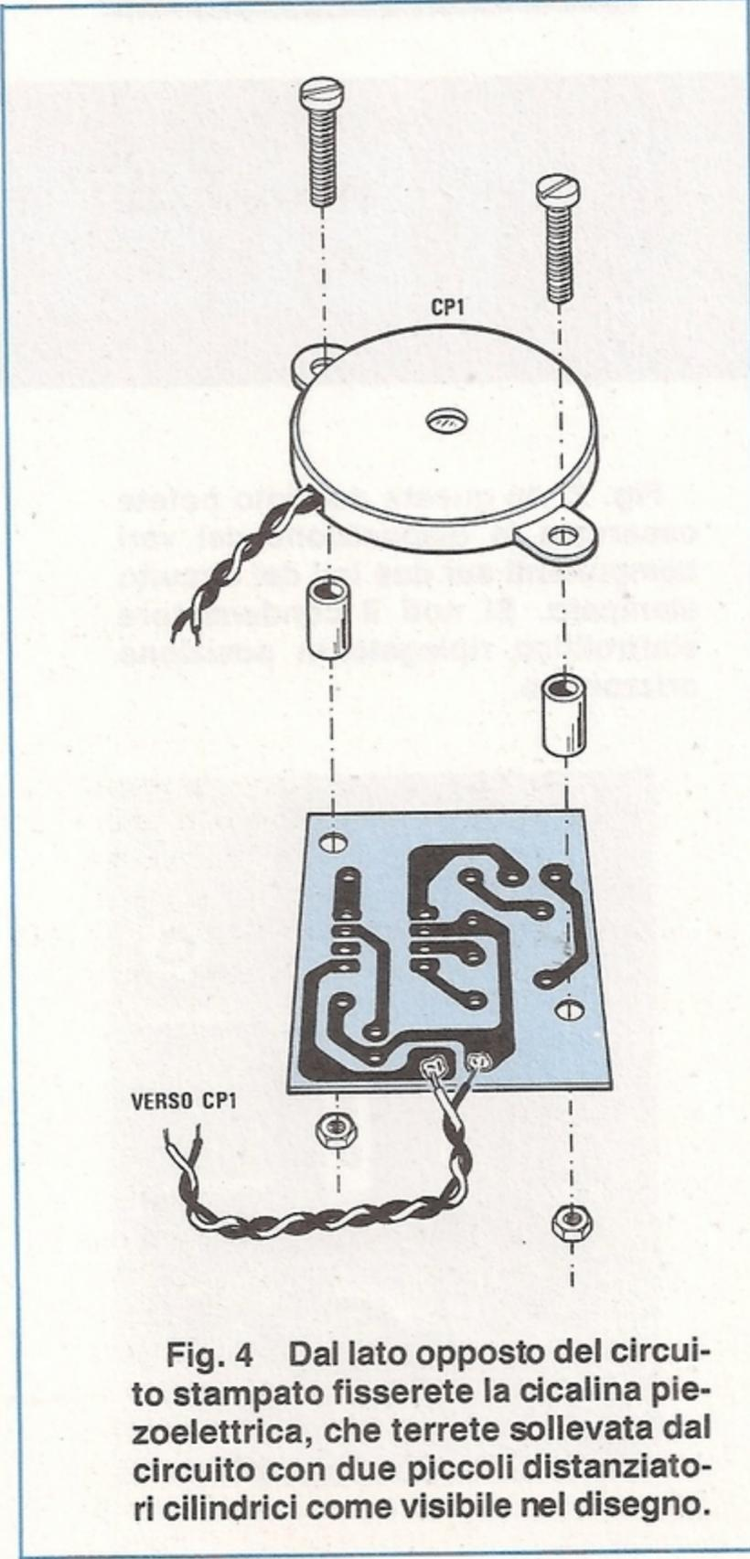
Fig. 4 Dal lato opposto del circuito stampato fisserete la cicalina piezoelettrica, che terrete sollevata dal circuito con due piccoli distanziatori cilindrici come visibile nel disegno.
