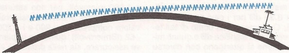
**Fig. 4** La ricezione di un segnale TV in via teorica dovrebbe risultare limitata all'orizzonte ottico, quindi, considerando la rotondità della terra, se l'antenna trasmittente non venisse collocata ad una elevata altezza non si riuscirebbe mai a superare una distanza considerevole.
