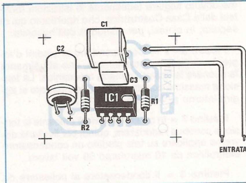
Fig. 3 Schema pratico di montaggio della cicalina vista dal lato dei componenti.
