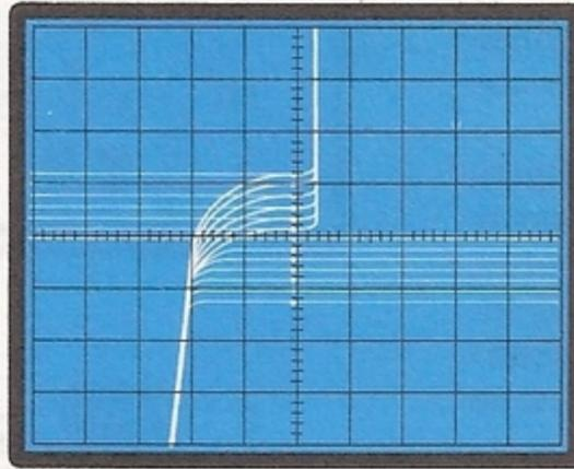
Fig. 29 Se le due tracce partono entrambe dalla 7<sup>a</sup> traccia, significa che la corrente di Gate è eccessiva.
